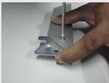
7) Fixação da Esquadreta
