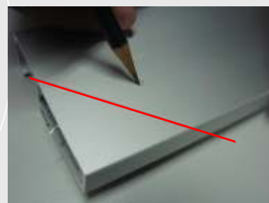
6) Fazer o Furo de fixação fora do centro para prender a esquadreta
